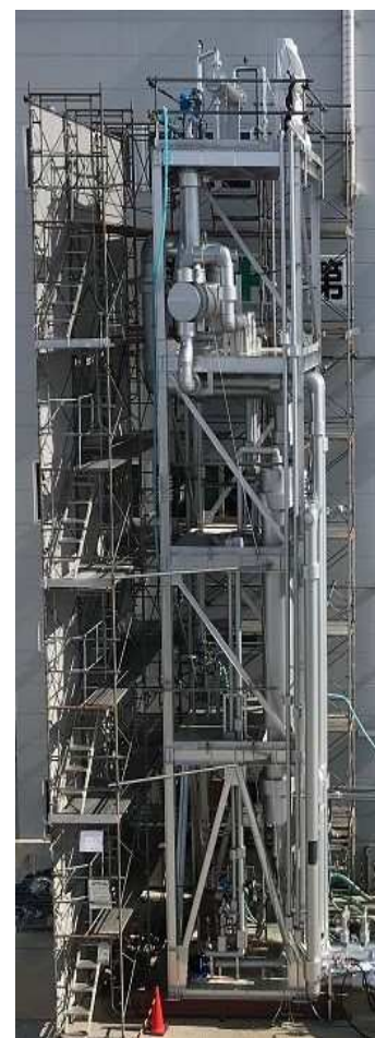
汎用ヒートポンプ式蒸留装置 (当社本社工場内に設置した試験機)
