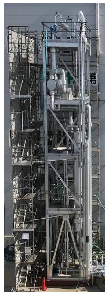
汎用ヒートポンプ式蒸留装置 (当社本社工場内に設置した試験機)
